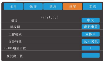
设置：中英文、面板锁定、工作模式、屏膜待机、RS485地址设置、恢复出厂值
