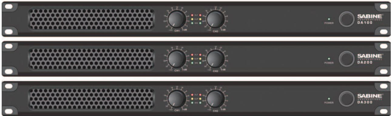
**DA**系列功率放大器是一款紧凑型的专业会议/多功能系列功放产品，包括DA100、DA200、DA300三款型号，每个型号均设计为两个输入通道、两个输出通道。全系列型号可选配对应的定压适配器（DA-T1、DA-T2、DA-T3），组合成高品质的70V/100V定压输出模式。
